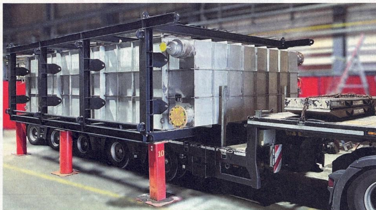
Verladung eines maßgeschneiderten Edelstahlwärmetauschers mit einer optimierten Leistung von 6.625 kW.
